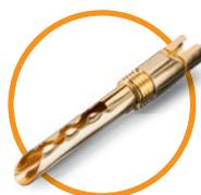
Die unkomplizierte Klemm-Zugentlastung des **HICON HI-BM13** garantiert nahezu vernachlässigbare Übergangswiderstände. Die Crimpung kann durch eine handelsübliche Klemmzange vorgenommen werden. Die ideale Leitfähigkeit erreichen Sie durch die Verwendung einer BNC/RG-Crimpzange. Der Bananenverbinder HI-BM13 besteht aus einem schraubbaren Gehäuse und einem straffen Lamellenkontakt.
